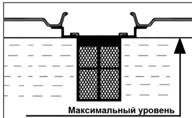
Рис. 10 Максимальный уровень топлива в топливном баке
