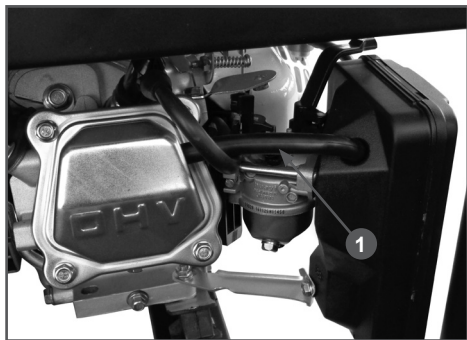
Рис. 14 Трубка системы вентиляции картера
